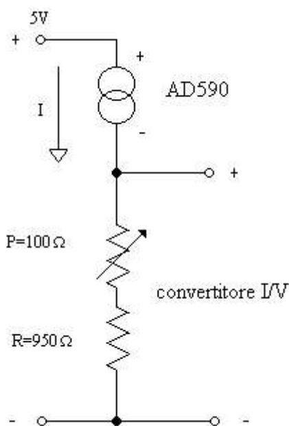
L'AD590 (sensore di temperatura) trasforma la temperatura in ingresso (°K), in corrente di uscita. Questo sensore ha una sensibilità di 1uA/°K.
