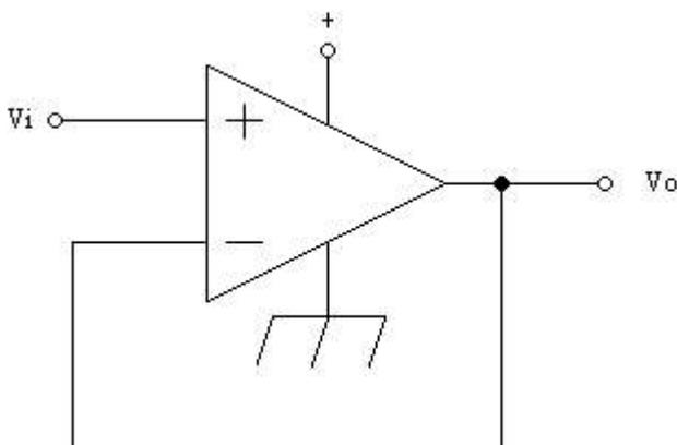
Gli Emitter Follower hanno la funzione di adattatori di impedenza, perché sono composti da un AO (amplificatore operazionale) che presenta una piccola resistenza d'ingresso e una alta in uscita.
